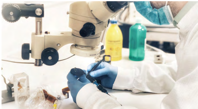
Abb. 1: Manueller Montageplatz mit Pinzette und Mikroskop
