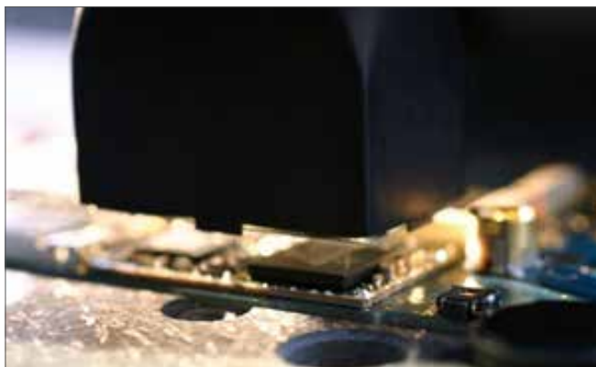
Abb. 5: Abheben des RF-Shield
