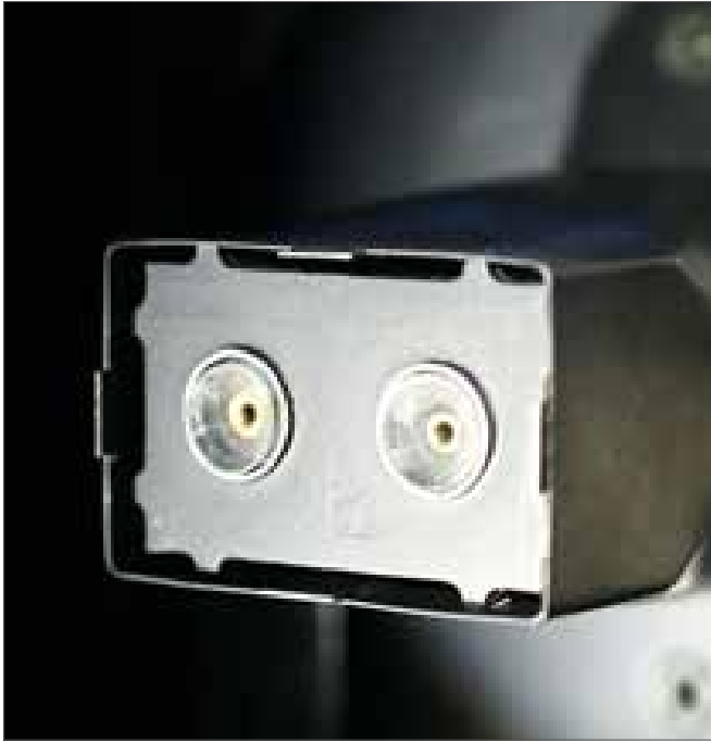
Abb. 2: Typischer RF-Shield Lötkegel
